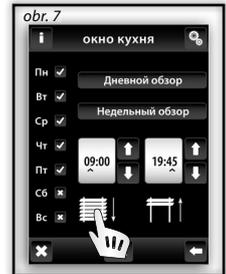
Ред.: Настройка Инверсии функции проводится нажатием на / в Недельной программе можно провести настройки режимов для жалюзи (рис. 7.)
